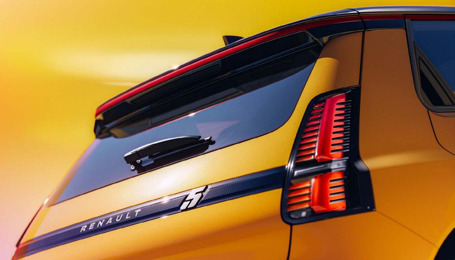
Transformado em indicador de carga, o número "5" acende-se quando o condutor se aproxima ou quando a carga da bateria é máxima.
